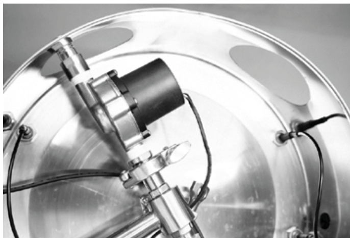
Posizione corretta della pompa
