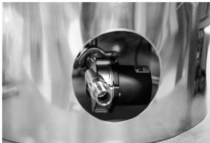
Posizione corretta della pompa
